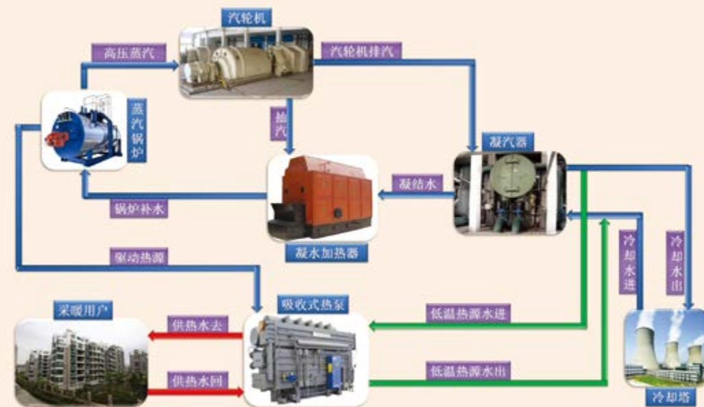
热泵与发电结合的能量梯级利用技术原理图
