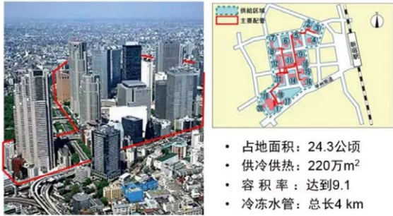
▲ 案例分析：世界最大的DHC系统——新宿新都心区域供冷供热系统
