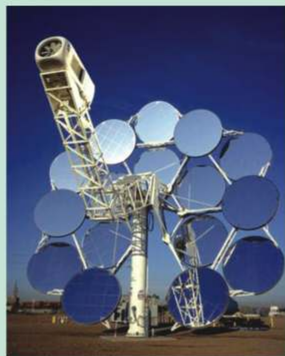
碟式系统由许多镜子组成的抛物面反射镜组成，接收器在抛物面的焦点上，接收器内的传热工质被加热到750°C左右，驱动发动机进行发电
